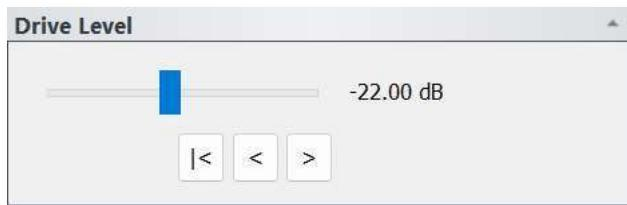
Stellen Sie den Drive Pegel im Bereich von -40,00 dB bis 0,00 dB in Schritten von 0,25 dB ein. Eine MER-Marge von 4 dB oder mehr ist sehr gut.
