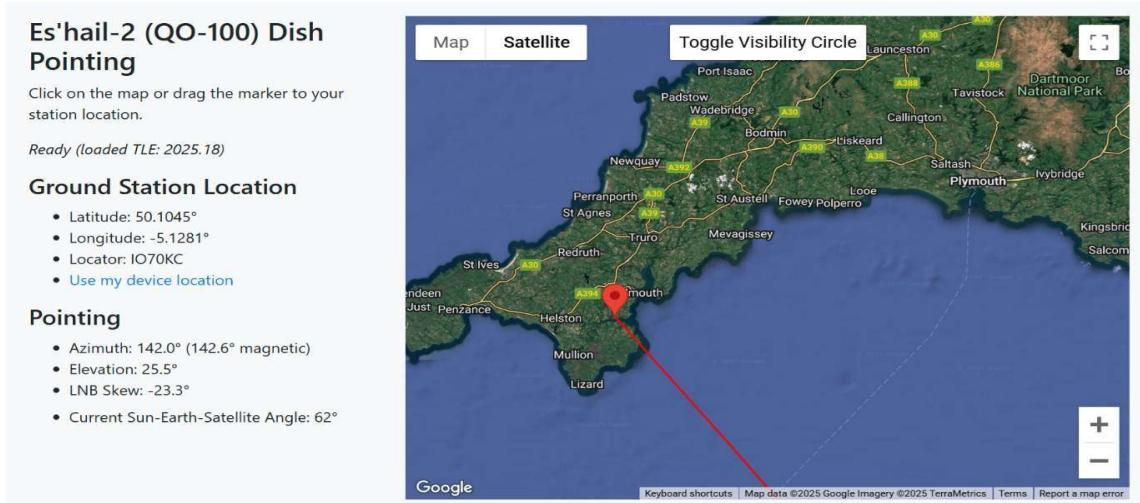
Eine empfohlene Methode zur Einstellung des Skew-Winkels besteht darin, das Signal des Schmalband-Transponder-Beacons zu beobachten und es auf den minimalen Signalpegel einzustellen, wobei der minimale Schmalbandsignalpegel dem maximalen Breitbandsignal entspricht.
